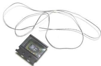
センサと センサをハンダ付けするための糸ハンダ
