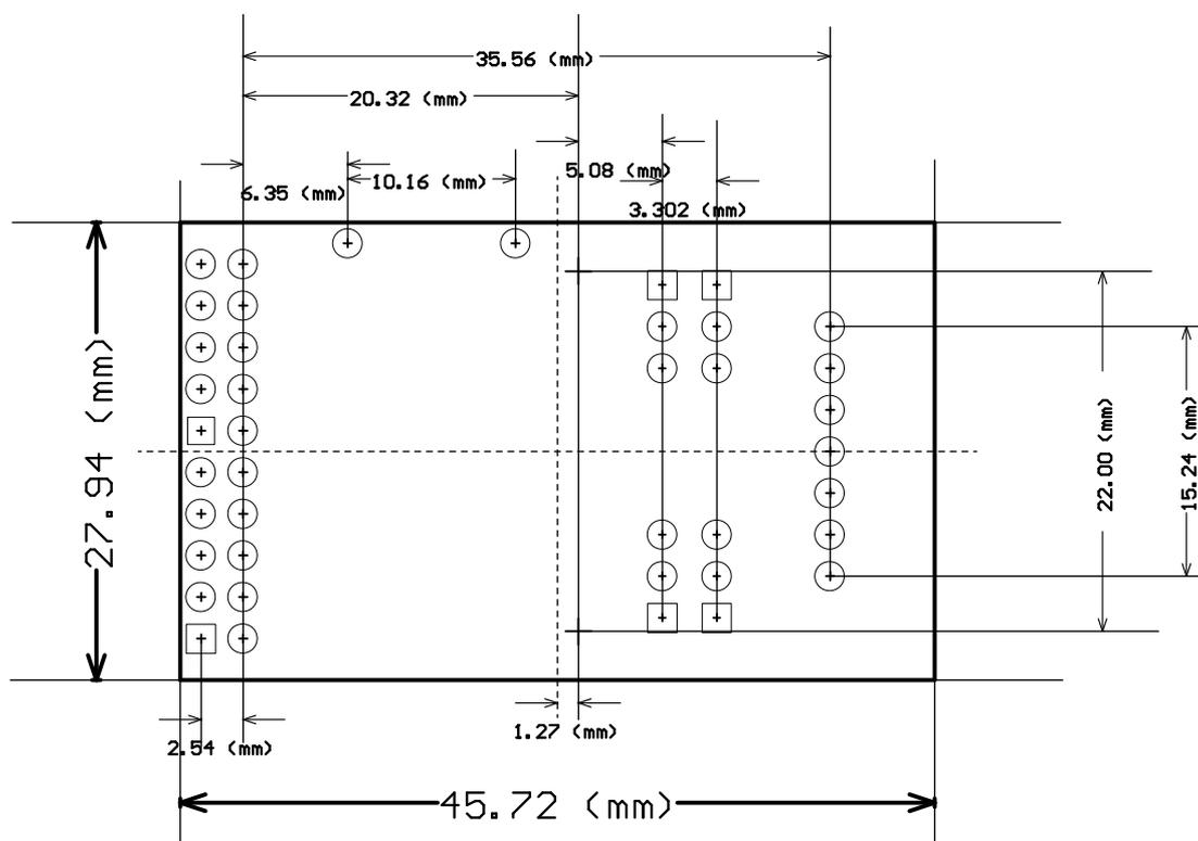
穴径は1.0mmです。2箇所の取り付け穴は3.2mm
