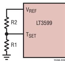
図8. T<sub>SET</sub>ピンのプログラミング
