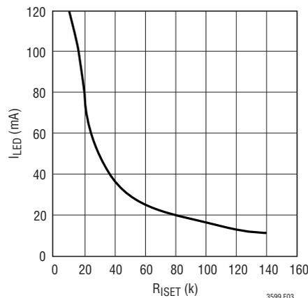
図3. LED電流のためのR<sub>SET</sub>値の選択
