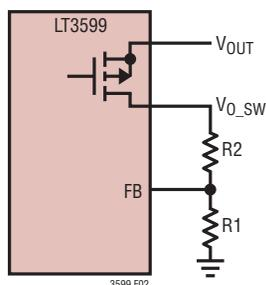
図2. 過電圧保護の電圧帰還接続
