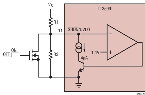
図10. ヒステリシス付き低電圧ロックアウト(UVLO)のプログラミング
