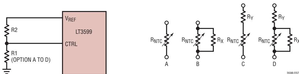
図7. NTC抵抗を使ったLED電流のディレーティングと温度
