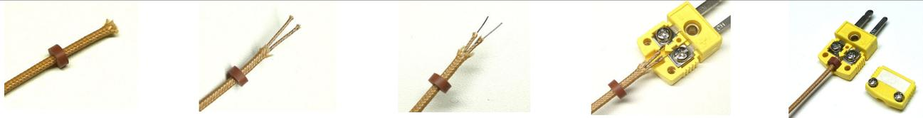
片側は溶接されて繋がっています。この溶接された接点が感温部です。絶対切り離さないようにしてください。被覆のほつれが邪魔な場合ははさみなどで取り除きます。反対側の端をコネクタにネジ止めします。被覆を剥がす前に丸いゴムプッシュを通しておかないと後から入れにくくなってしまいます。写真のように被覆をニッパーなどで剥いてください。被覆の繊維がかなり出ますのでゴミ箱の上などで行うといいでしょう。2本の線はどちらも茶色で極性がわかりにくいですが、+極側には少し青い繊維がスパイラル状に入っています。解らない場合は一度繋いでみて温度が逆に変化する場合繋ぎなおしてください。写真では解りやすくするため長くしておりますが、実際はもっと詰めないとコネクタ内に収まりません。
