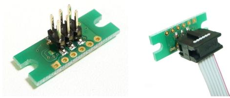
← L型ピンヘッダの根元部分にハンダを流し込んでハンダ付けができます。
